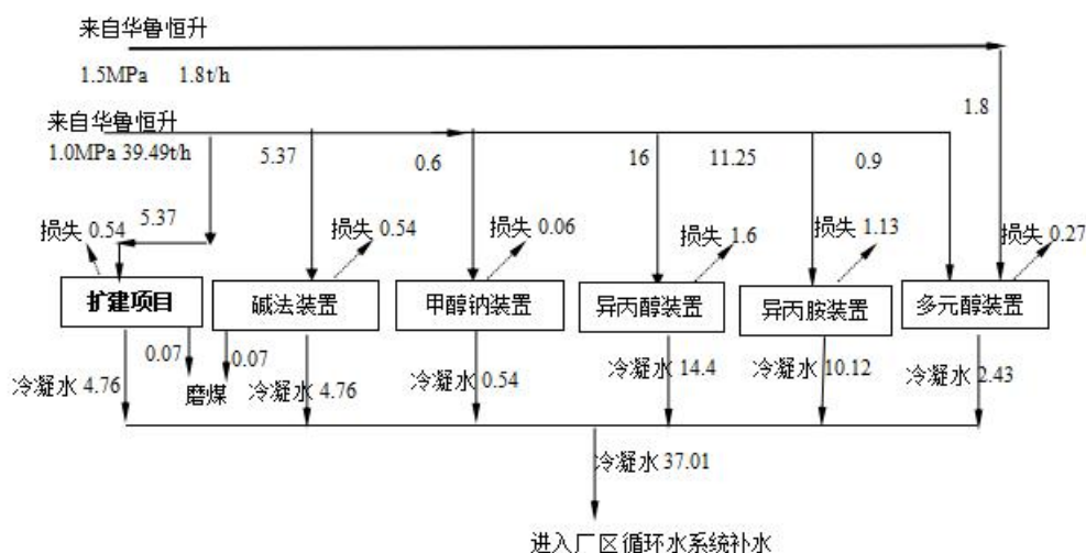
图 3-8 验收阶段全厂生产蒸汽平衡图 (t/h)
